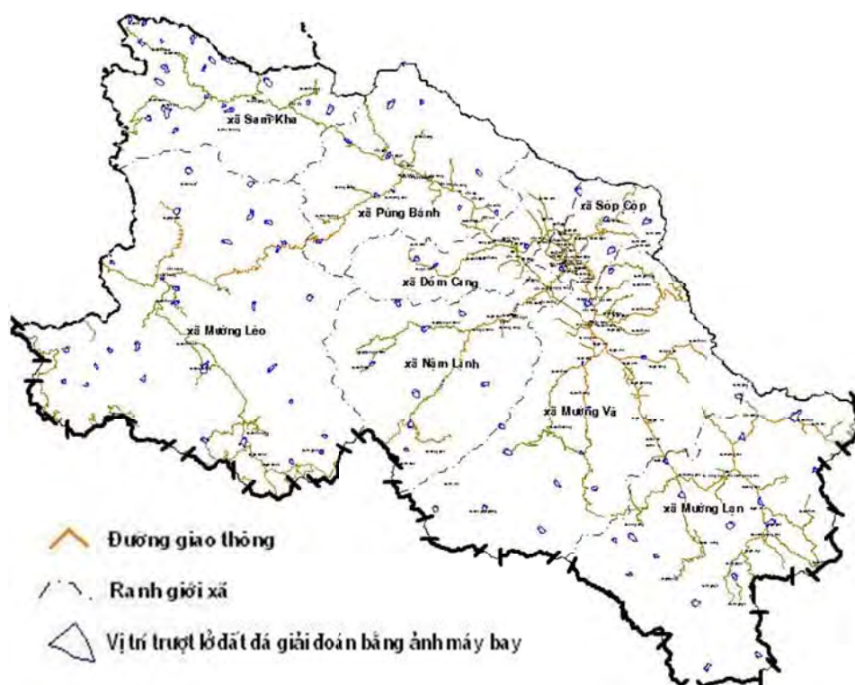
Hình 38: Sơ đồ giải đoán hiện trạng trượt lở đất đá trên địa bàn huyện Sốp Cộp.
