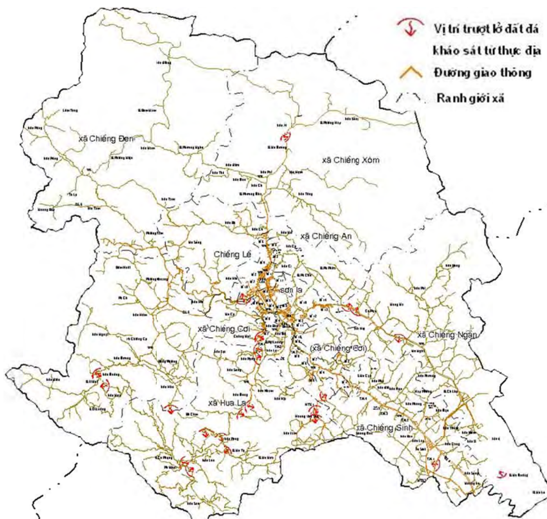
Hình 43: Sơ đồ hiện trạng trượt lở đất đá trên địa bàn Thành phố Sơn La.
